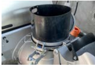
Hazne bağlantısı Styropor torbalar için, lastik bantlı, kolay menteşeleme
