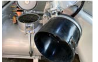
Hazne bağlantısı Styropor torbalar için, lastik bantlı, kolay menteşeleme
