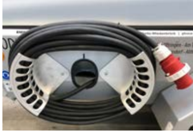
Besleme kablosunun kolayca sarılması için kablo tutucu.
